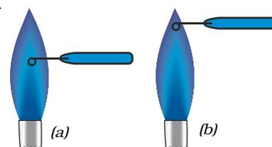
Fig. 7.4 : Borax bead test
